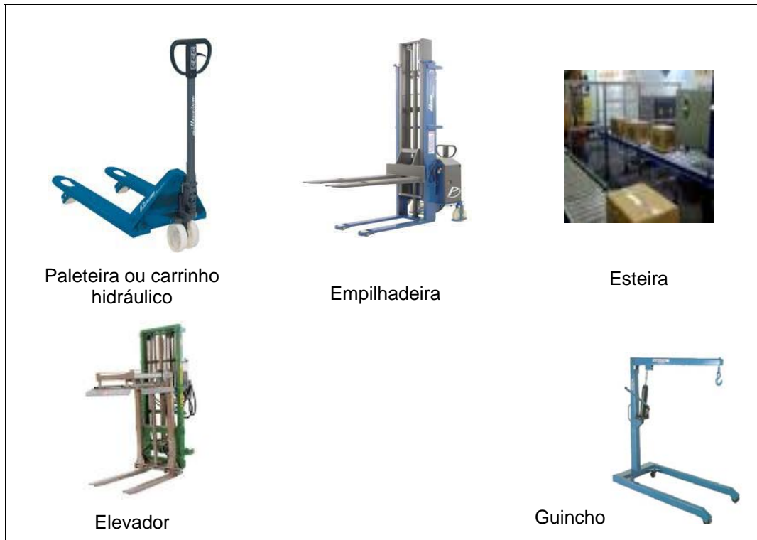
Figura 1 - Equipamentos de Manuseio - Sistemas Mecanizados.
