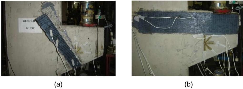
Figura 5.3 – (a) ruptura por destacamento da fibra; (b) ruptura por fendilhamento da biela.
