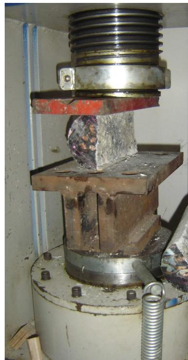
Figura 4.9 – Ensaio de resistência à tração do concreto por compressão diametral.
