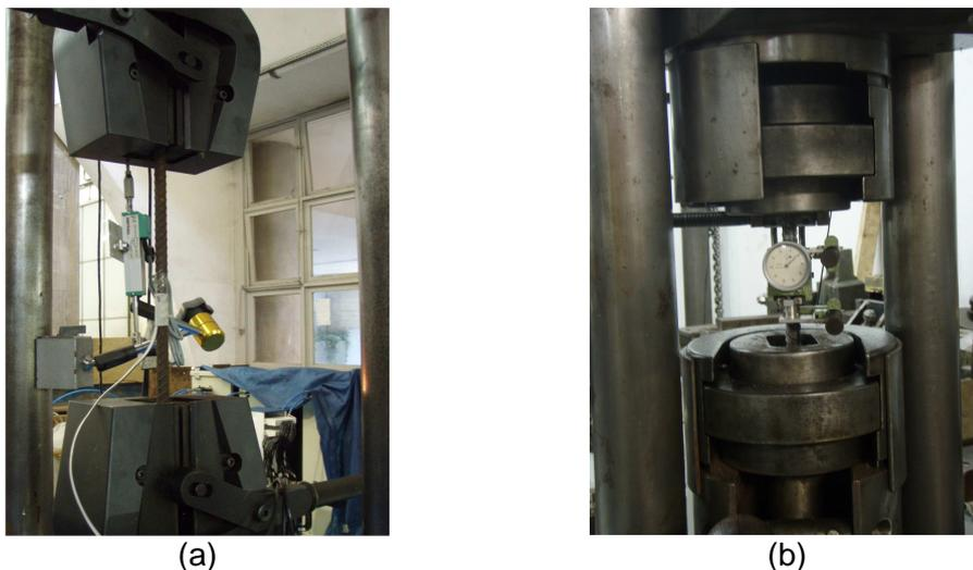
Figura 4.3 – Ensaio à tração dos corpos-de-prova: (a) Laboratório de Estruturas e Materiais; (b) ITUC.
