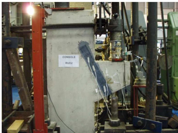
Figura 4.23 – Esquema de ensaio do console RUD2.
