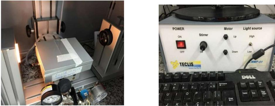
Figura 11: Foto à esquerda mostra a câmera, lâmina de vidro e a fonte de luz. A foto à direita apresenta o hardware que controla o aparato.
