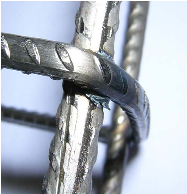
Foto 8: Detalhe da solda de um fio de 4,2 mm com aço 0,10%C em uma barra de 8 mm com aço 0,23 %C e 0,22 %V.
