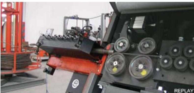
Foto 5: Alimentação de máquina de corte e dobra. [13]
