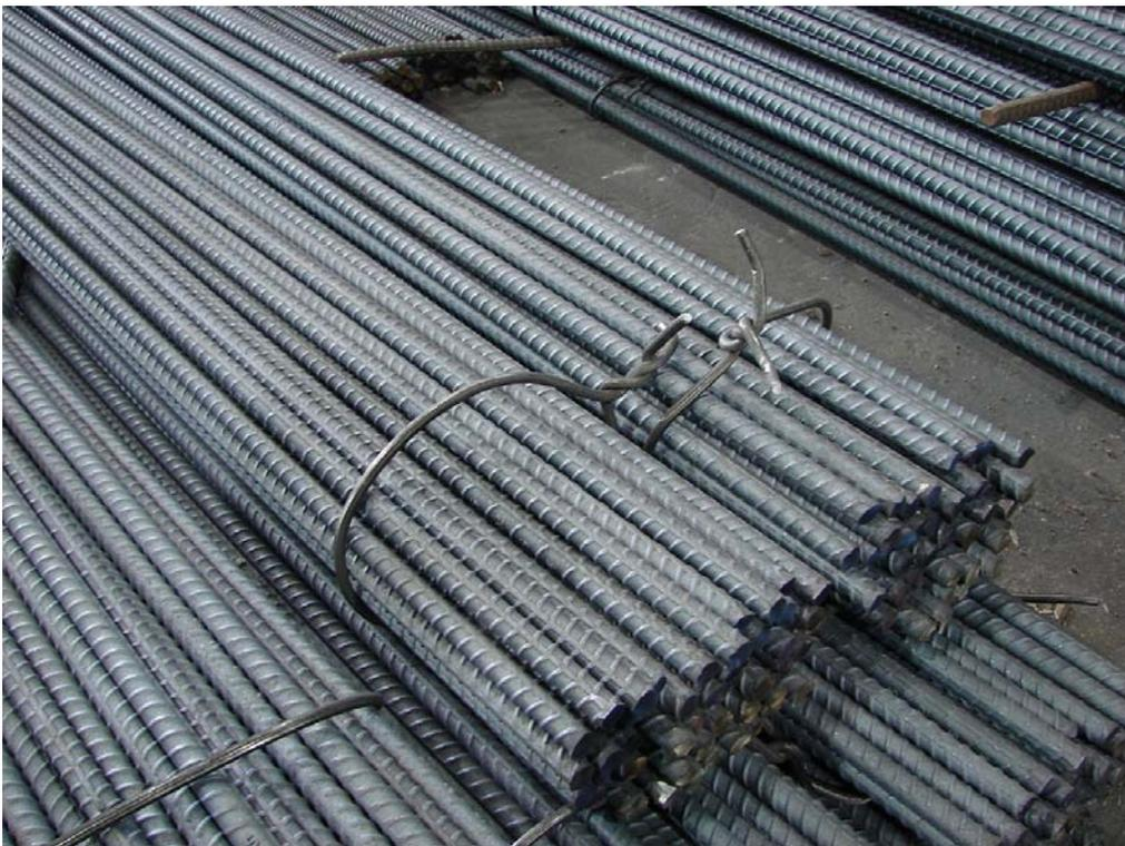
Foto 3: Barras nervuradas (vergalhão) para reforço de estruturas de concreto.
