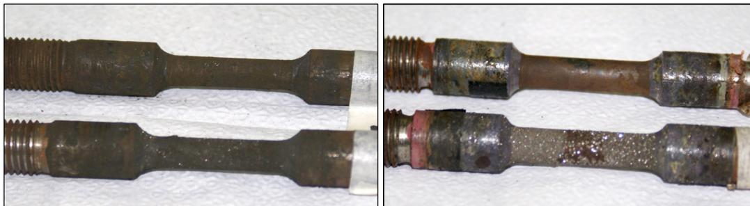
Figura 198. Macros das diferentes morfologias e espessuras obtidas para os Cps submetidos as mesmas condições de ensaio em testes NACE. (direita) Junta X80-2 em ambiente com  $\text{pH}=3,4$ ,  $P_{\text{H}_2\text{S}} = 0,5763$  e 85%LE. (esquerda) MB X80 em ambiente com  $\text{pH}=3,4$ ,  $P_{\text{H}_2\text{S}} = 0,688$  e 90%LE.
