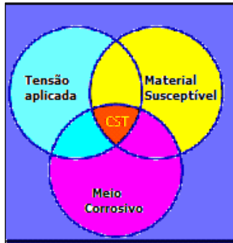
Figura 12. Condições para corrosão sob tensão [37] .
