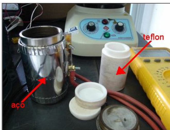
Figura 3 - Partes que compõem a autoclave.
