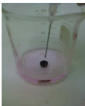
Figura 24 – Solução de Tween 80 gotejada sobre o cupom antes da ação mecânica.
