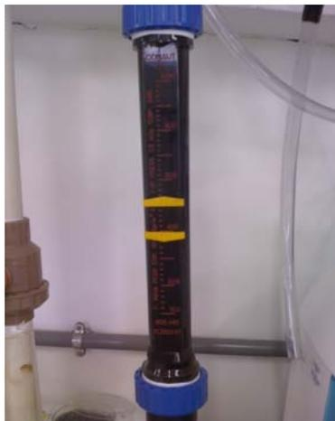
Figura 14 – Rotâmetro inserido no sistema.
