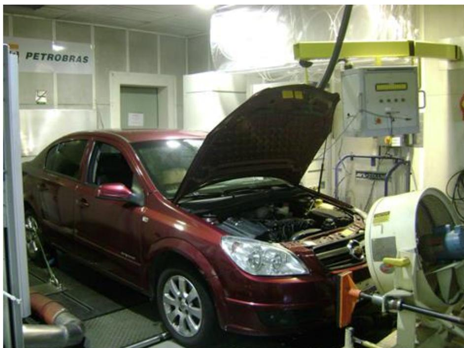
Figura 4.11 – Veículo durante ensaios de autonomia.
