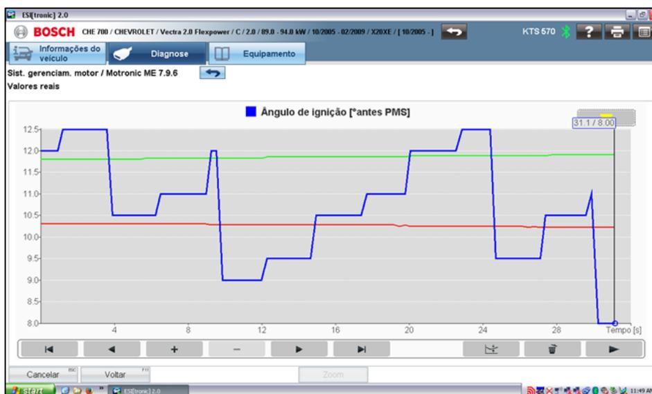
Figura 4.16 – Tela do *scanner Bosch [ESI]tronic 2.0* com os valores de avanço de ignição.
