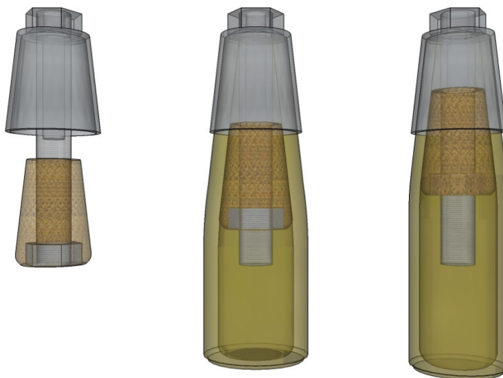
Figura 86: Sistema de ponteira ideal, com inclinação de 6^\circ capa de ponteira em tronco de cone mais longa, sistema de aperto invertido (mantendo a conexão externa regularmente posicionada) e exemplos de aplicação a colmos com parede de 7 e 5mm respectivamente, antes do pré-tensionamento.
