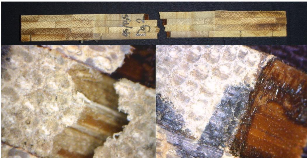
Figura 41: Corpo-de-prova rompido e dois dos modos de ruptura apresentados pelo laminado submetido à tração, respectivamente cisalhamento tipo 1 e descolamento.
