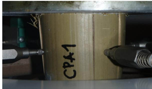
Figura 32: Gráfico força x deslocamento transversal e fotografia do corpo-de-prova 1 ao término do ensaio.
