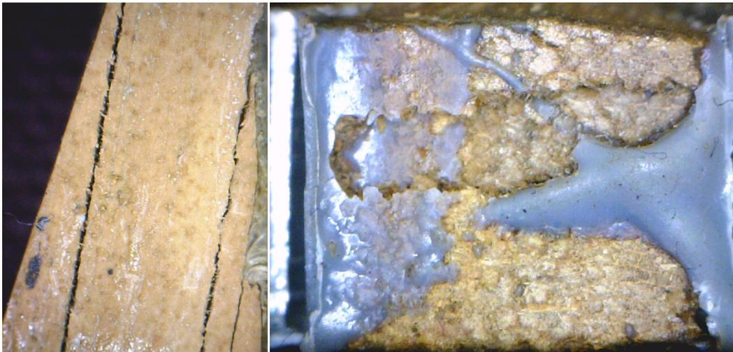
Figura 30: Ruptura na zona de transição alinhada com a zona de estrição e vista do topo do corpo-de-prova com a trinca propagada até a área de pinçamento e o descolamento das placas de alumínio.
