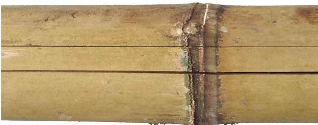
Figura 4: Trincas longitudinais em um colmo de bambu da espécie *Dendrocalamus giganteus*.
