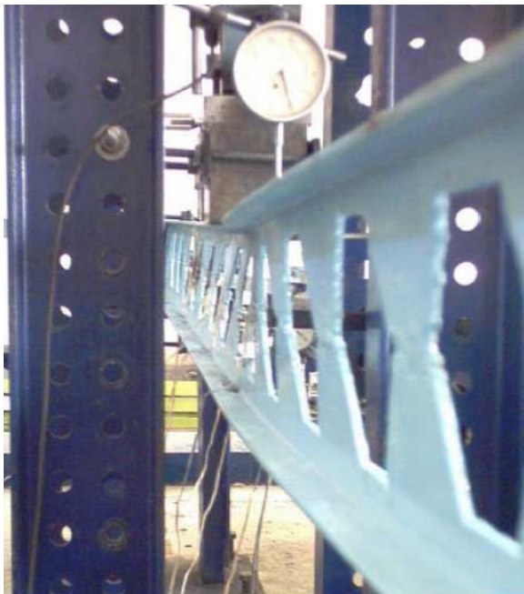
Figura 2.9 Ensaio de viga castelada [21]
