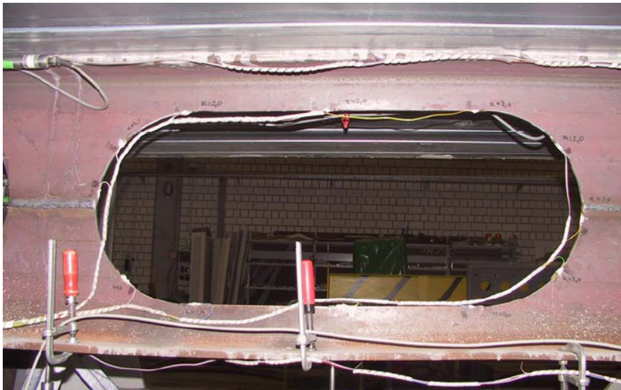
Figura 2.5 - Abertura circular alongada aparelhada para ensaio [19]
