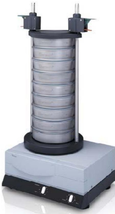
Figura 36 – Separador de partícula por frações da Restch, modelo AS200 (<http://www.retsch.com>).
