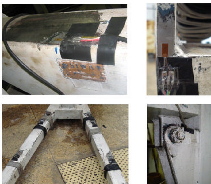
Figura 6.17 - Pontos Instrumentados na estrutura.
