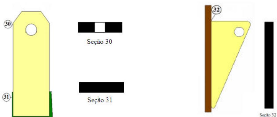
Figura 5.5 - Pontos analisadas nos Elementos 5 e 6 , respectivamente, suporte da articulação e suporte do cilindro.
