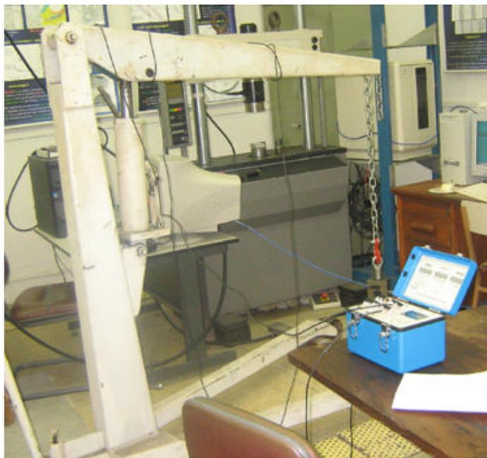
Figura 3.3 – Guincho Hidráulico – Laboratório de Fotomecânica PUC-Rio.
