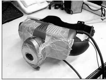
4.2(a): *HMD* com uma câmera acoplada para permitir *AR* do tipo *Video See-Through*.
