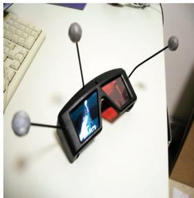
4.13(b): Óculos estereoscópico do tipo anaglifo com marcadores de rastreamento óptico.
