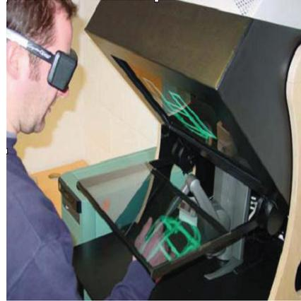
2.9(b): Setup utilizando superfície semi-transparente.
