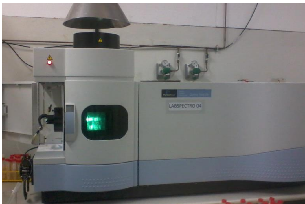
Figura 16 Equipamento ICP OES modelo Optima 7300 da Perkin Elmer.
