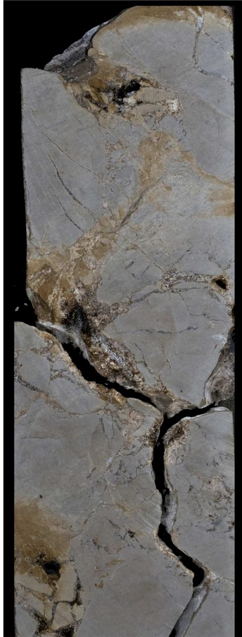
*Figura 2-5: Parede do poço com existência de fraturas*
