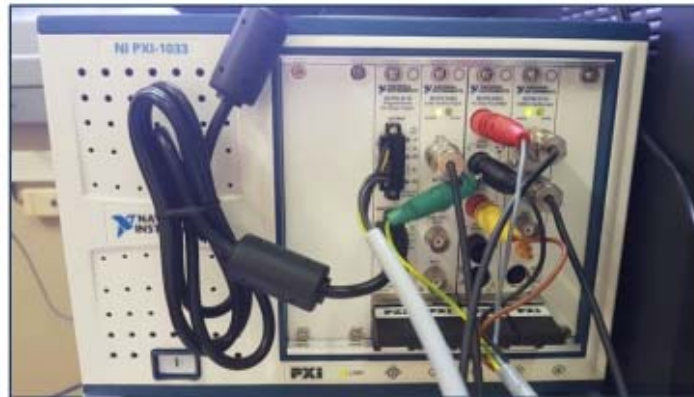
Figura 2 – Placa PXI com os componentes conectados.
