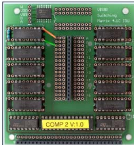
Figura 4 – Placa de componente do VISIR mostrando a ligação de um resistor (I. Gustavsson, 2008).
