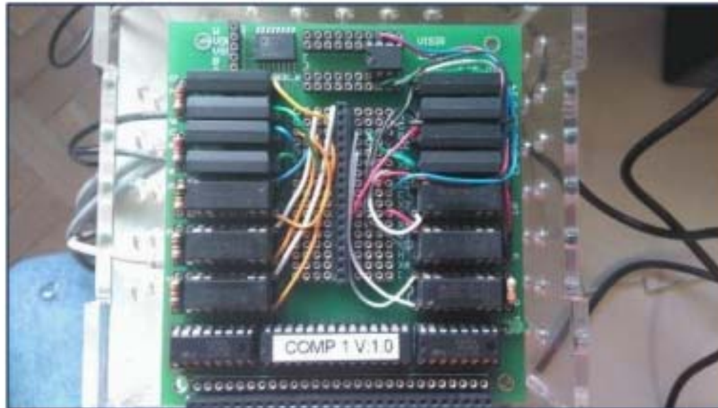
Figura 5 – Placa de componente 1 do VISIR da PUC-Rio com a configuração instalada em 02.set.2016.
