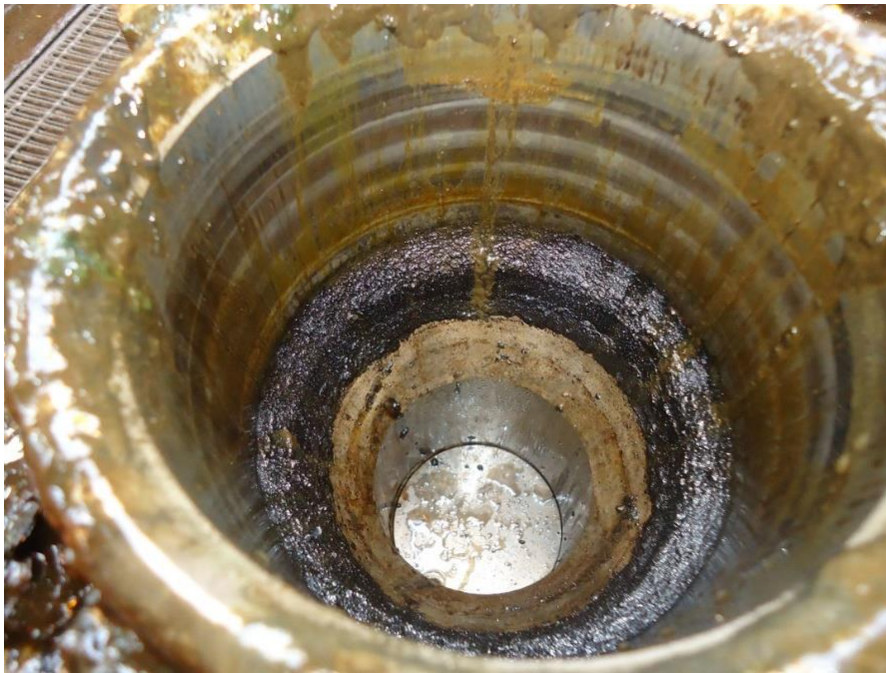
Figura 1.2: Foto de parafina depositada em árvore submarina de teste. (Petrobras).
