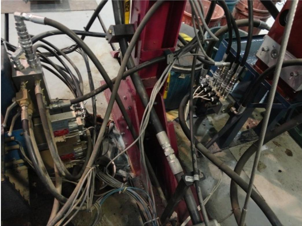
Figura 3.8. Detalhe da unidade de carregamento lateral
