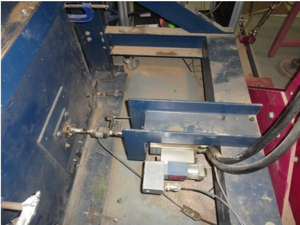
Figura 3.9. Detalhe da unidade de carregamento lateral
