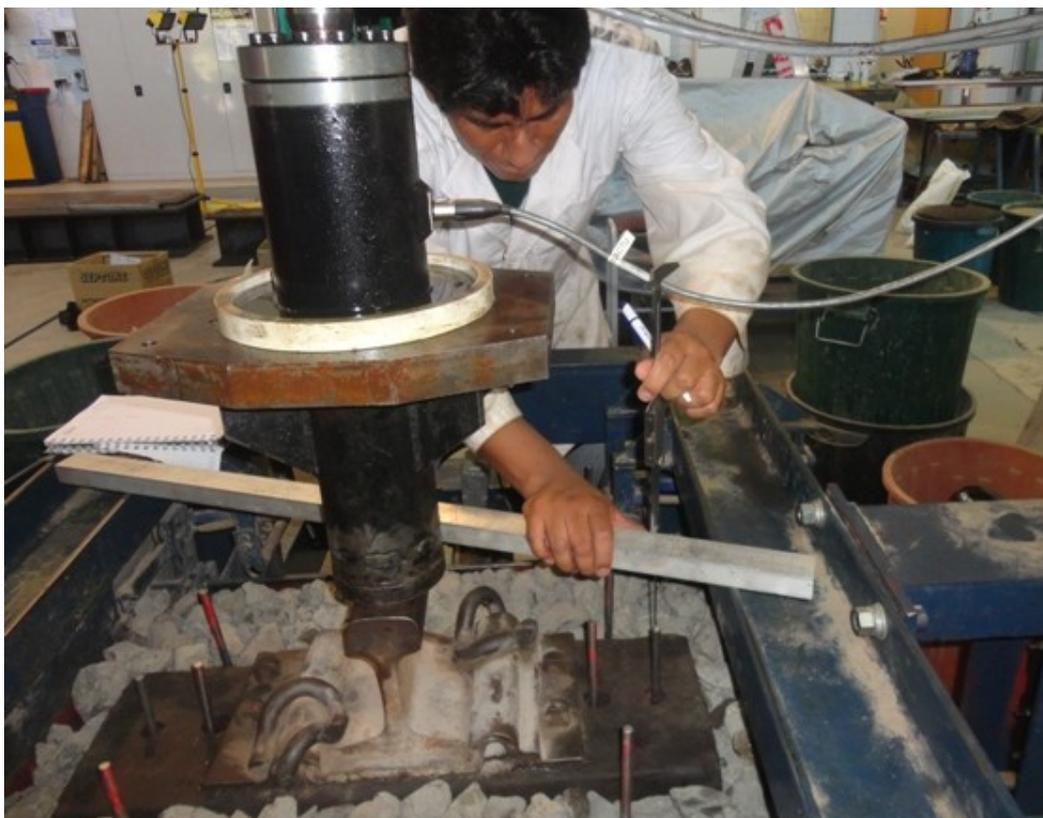
Figura 3.30. Medição dos deslocamentos verticais.
