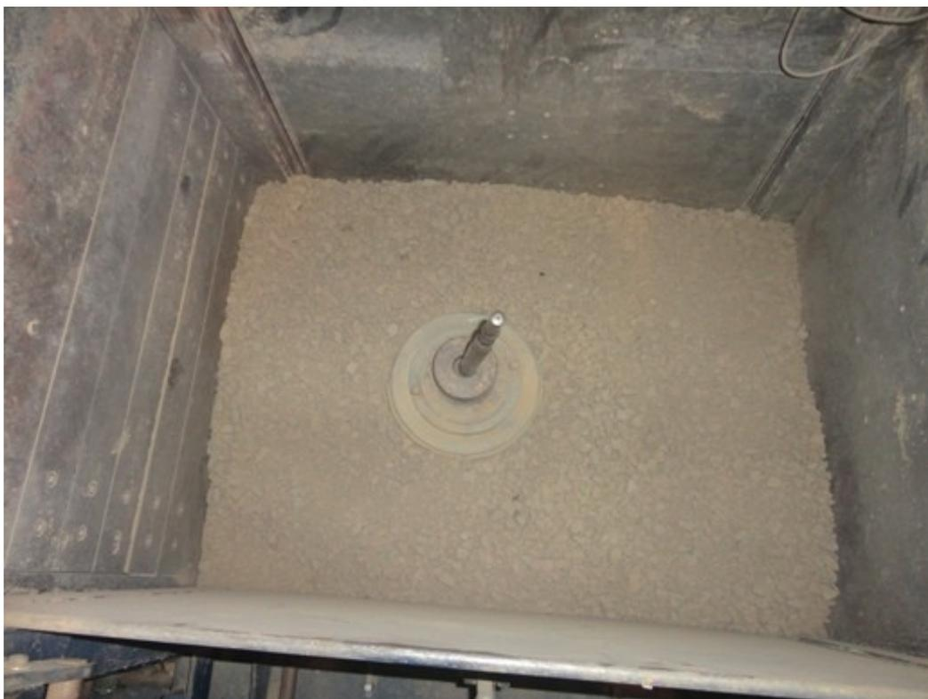
Figura 3.22. Compactação de camada de sublastro.
