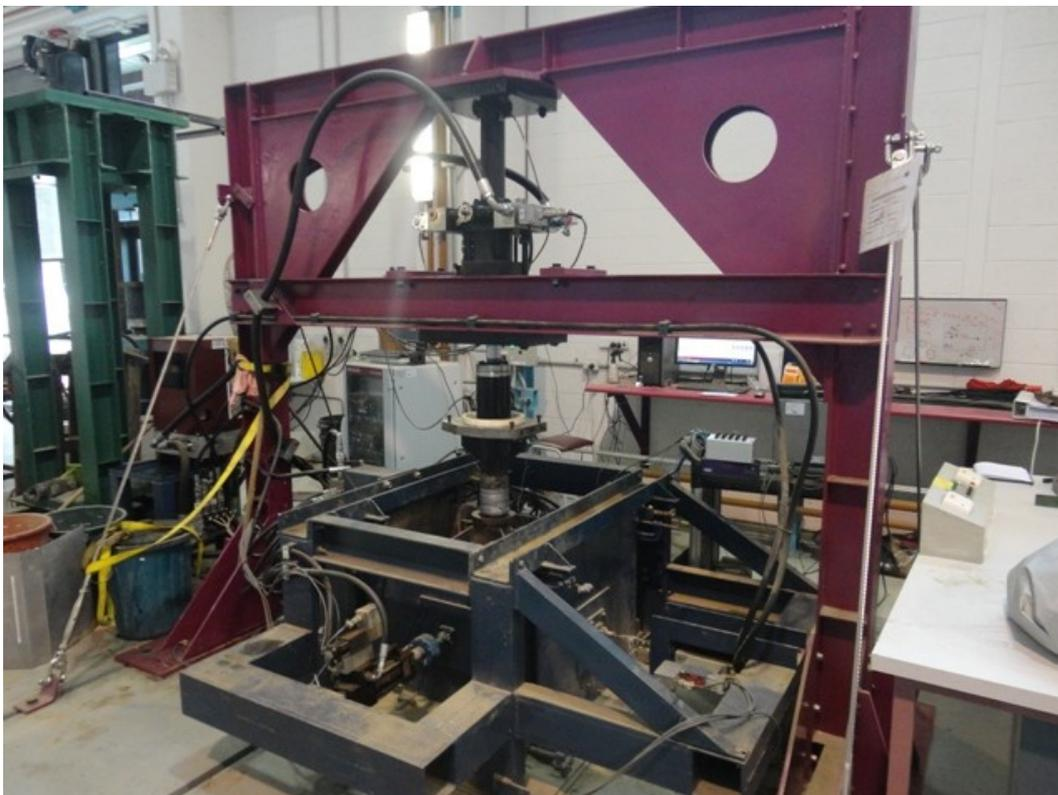
Figura 3.1. Equipamento triaxial prismoidal cíclico da Universidade de Wollongong na Austrália.
