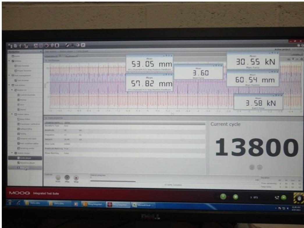
Figura 3.11. Tela de controle do atuador de carga marca MOOG.
