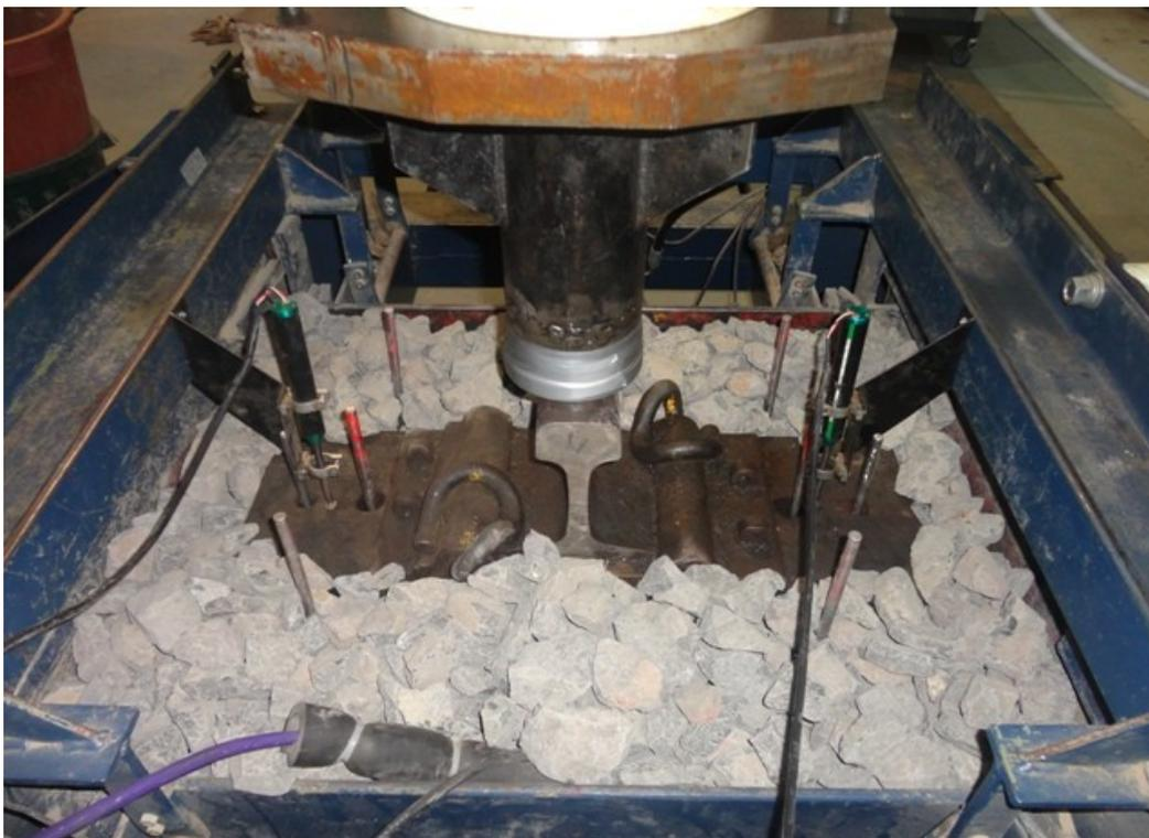
Figura 3.29. Colocação de LVDTs no dormente.
