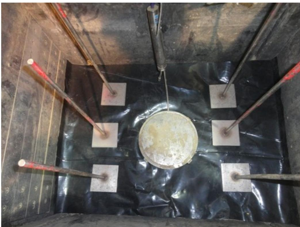
Figura 3.23. Arranjo da instrumentação na interface sublastro-lastro.
