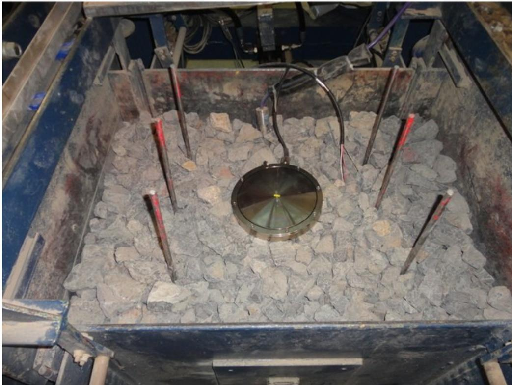
Figura 3.24. Vista superior do topo do lastro de suporte antes de colocar o dormente.
