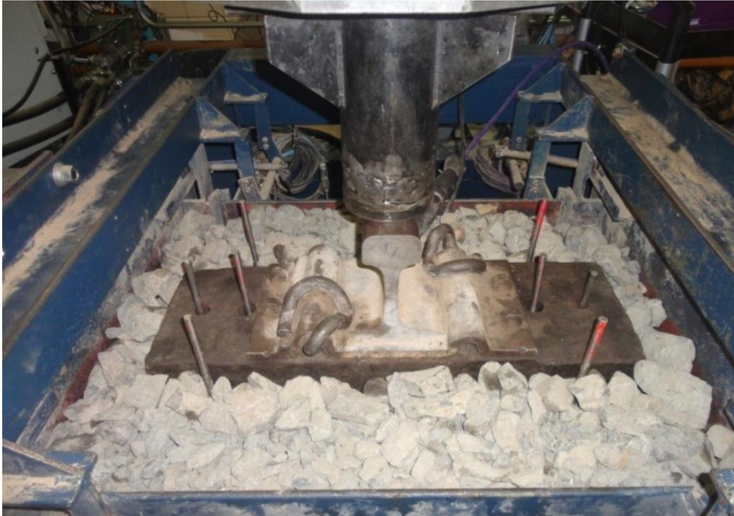
Figura 3.28. Topo da câmara triaxial mostrando dormente e trilho.
