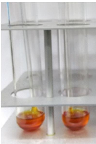
**Figura 33.** Foto do resíduo formado após o ensaio de Rancimat<sup>®</sup> da amostra B20 S10 (realizado em duplicata) no tempo 6 semanas.
