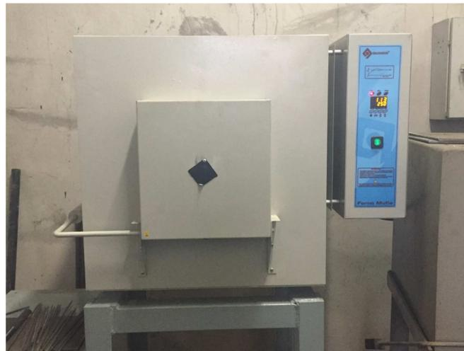
**Figura 27 - Forno mufla para ensaio de exposição à alta temperatura.**
