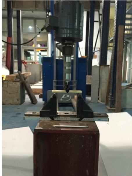
**Figura 25 - Dispositivo para ensaio de flexão em três pontos do Laboratório de Estruturas e Materiais da Civil.**
