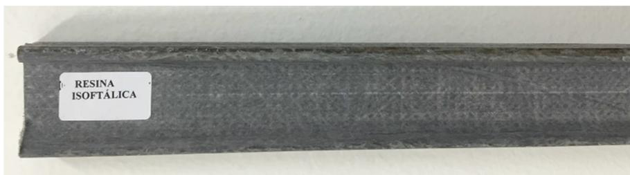
**Figura 17 - Perfil I em resina isoftálica reforçada com fibra de vidro.**
