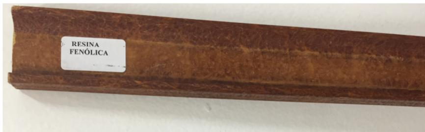
**Figura 19 - Perfil I em resina fenólica reforçada com fibra de vidro.**
