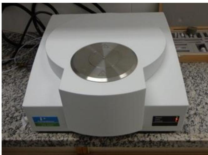
Figura 3-8- Analisador Térmico simultâneo DSC/TG usado na pesquisa.
