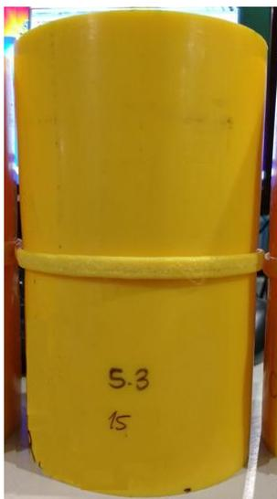
Figura 3-6- Formato do corpo de prova para teste de rigidez.
