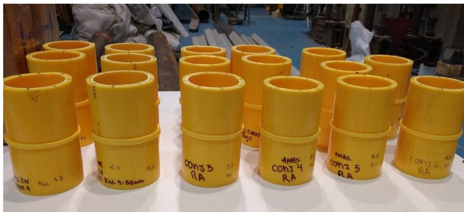
Figura 3-2– Tubos de PA12 soldados por termofusão.
