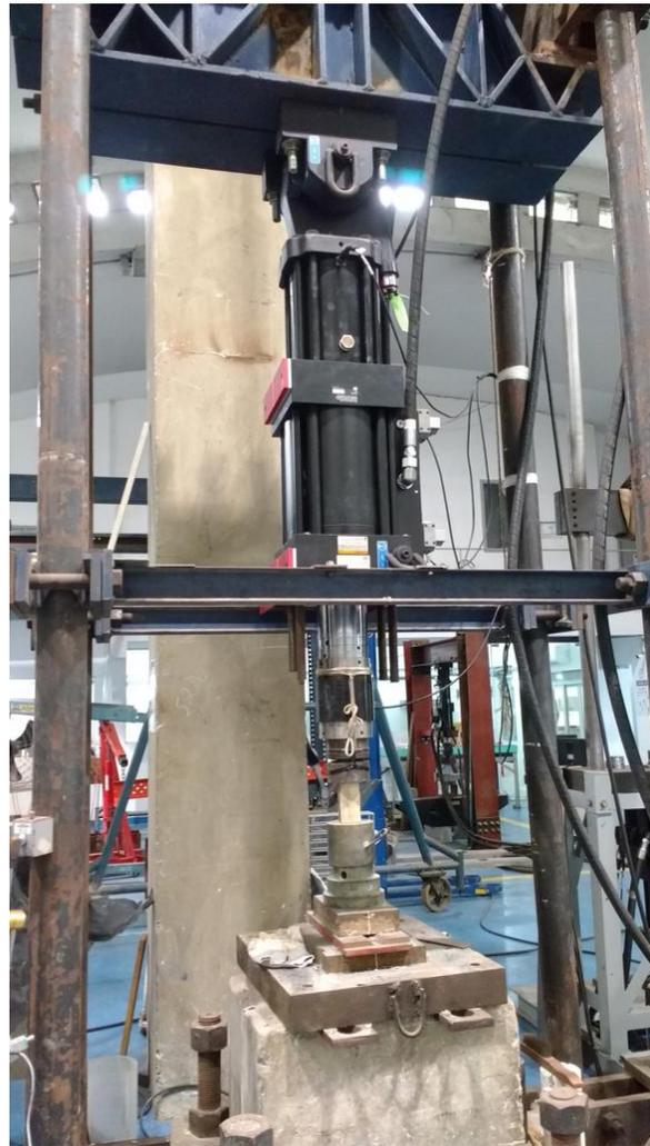
Figura 3-7– Equipamento utilizado para os ensaios de rigidez.
