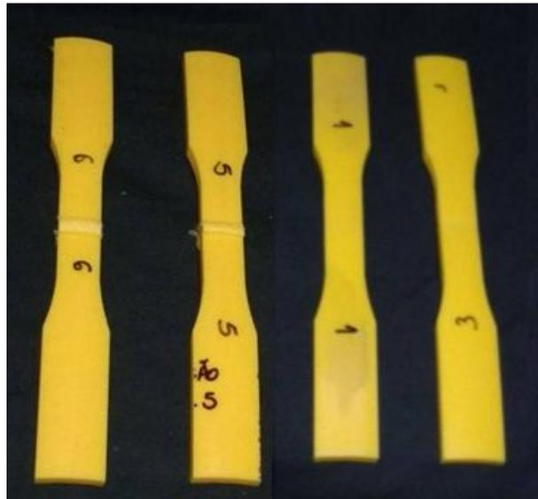
Figura 3-4– (a) Corpos-de-prova com rebarba (b) Corpos-de-prova sem rebarba
