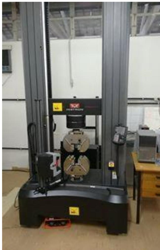
Figura 3-5- Máquina de ensaio universal - modelo INSTRON 598.
