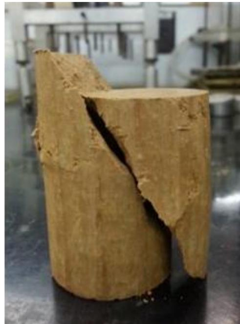
Figura 60: Corpo de prova antes e após o ensaio de compressão simples.
