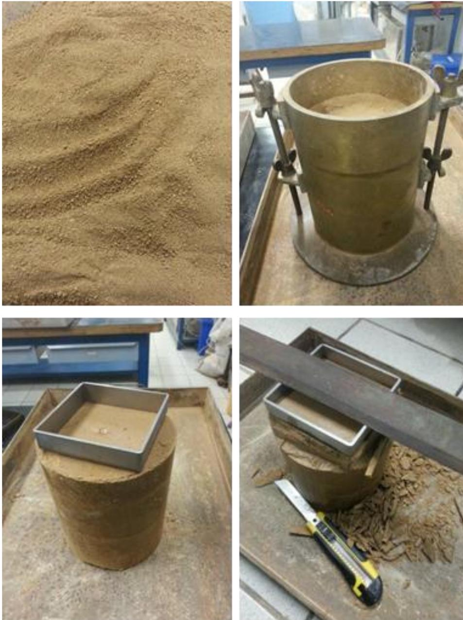
Figura 57: Preparação das amostras para o ensaio de cisalhamento direto.
