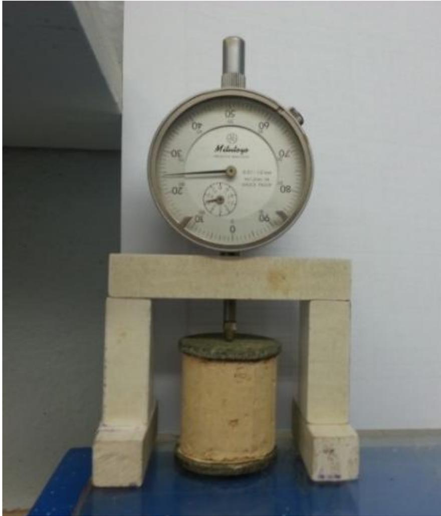
Figura 67: Equipamento do Ensaio de Contração.
