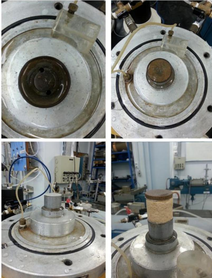
Figura 64: Montagem e acomodação da amostra.
