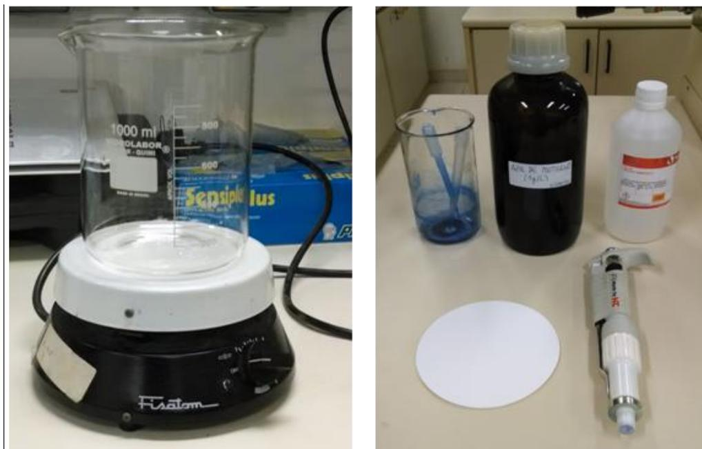
Figura 48: Agitador mecânico e materiais para o Ensaio de Azul de Metileno.
