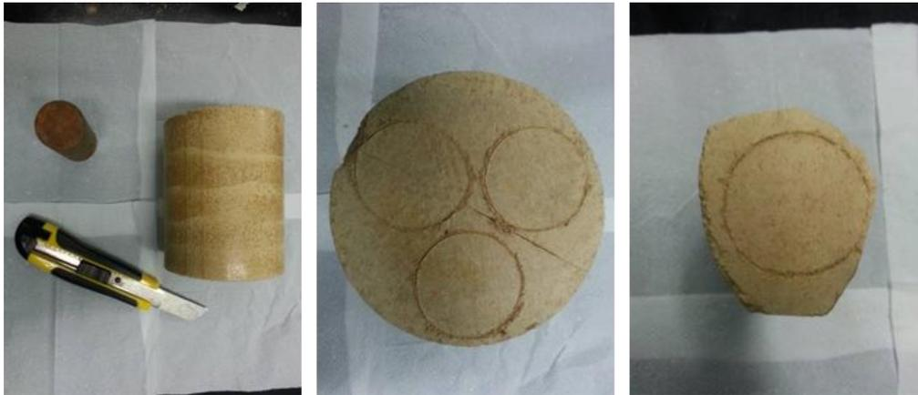
Figura 53: Obtenção de amostras para as análises de MEV.
