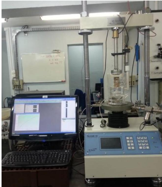
Figura 59: Equipamento utilizado nos ensaios de compressão simples.
