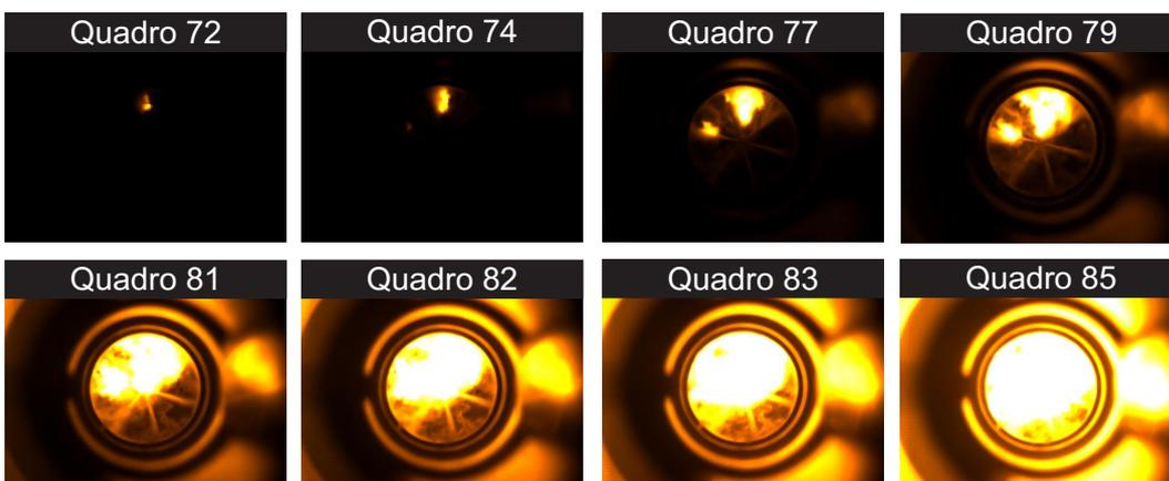
Figura 5.28: Ignição e combustão no teste da mistura etanol e PEG400 (20%), 1750 rpm,  $RC = 20,83:1$  e  $IDI = 5,60$  mm ( $\sim 24^\circ$  - Quadro 6) antes do PMS. Imagens a 30.000 qps.
