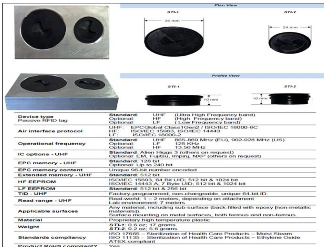
Figura 45: Exemplos de tag on metal STI1 e STI2 Fonte: TROI (2013)
