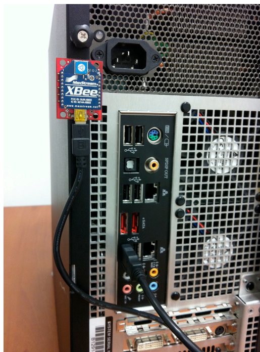
Figura 3.11: Estação de controle de rastreamento e feedback tátil com o modem XBee
