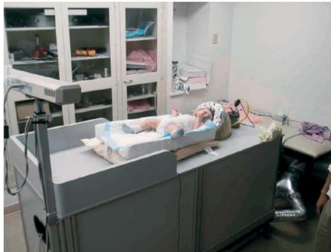
Figura 9 - Biomagnetômetro Neonatal BabySQUID [1].
