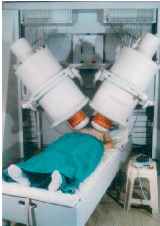
Figura 8 - Biomagnetômetro Twin-Dewar de 62 canais [1].
