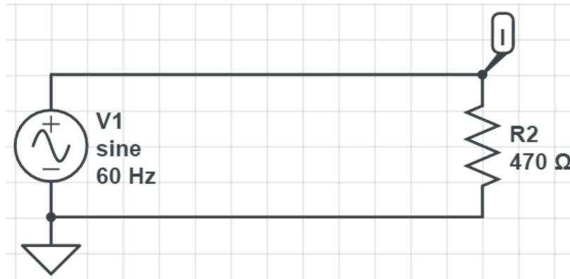
Figura 3: Circuito Resistivo alimentado por corrente alternada no *Circuitlab*.
