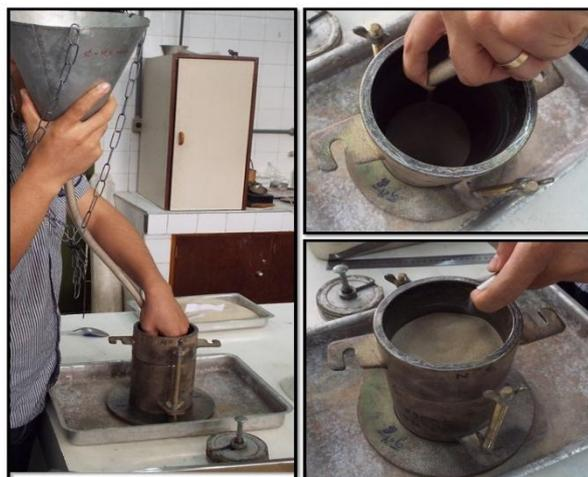
Figura 3.1 - Colocação da areia no molde de ensaio.
