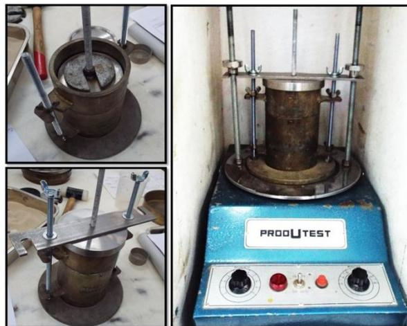
Figura 3.2 - Sequência de colocação da sobrecarga na amostra e fixação do conjunto a ser ensaiado na mesa vibratória.
