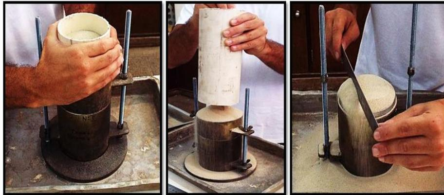
Figura 3.5 - Levantamento do tubo de parede rígida e nivelamento da areia do molde.
