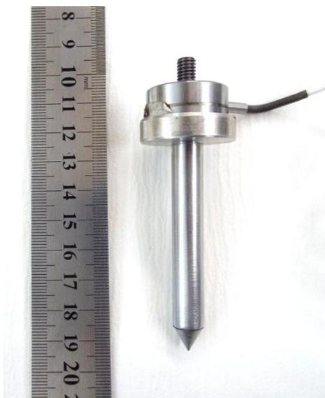
Figura 3.19 - Arranjo do ensaio de mini-CPT.
