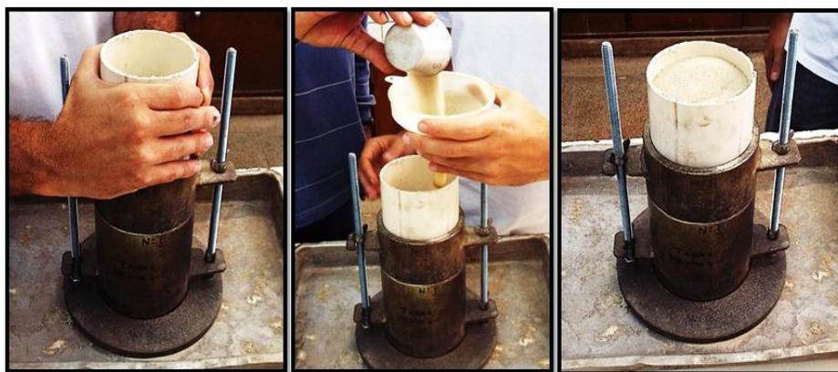
Figura 3.4 - Sequência da colocação da areia no molde de ensaio.
