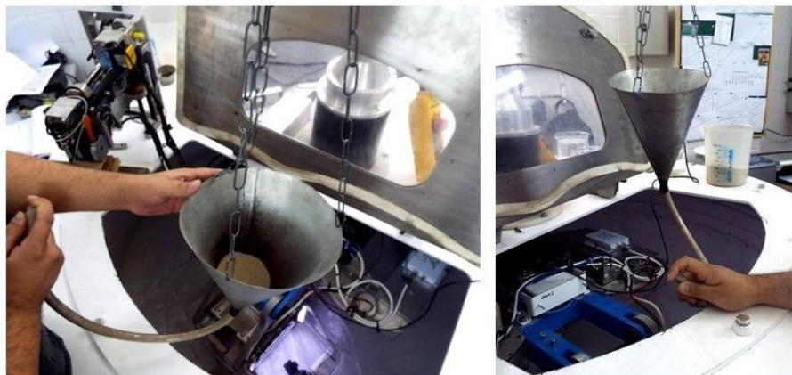
Figura 3.7 - Areia colocada no funil (esquerda) e funil posicionado para a pluviação (direita).
