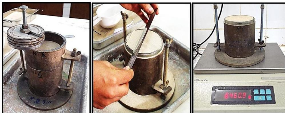
Figura 3.3 - Retirado de sobrecarga, nivelamento e pesagem da amostra do ensaio.
