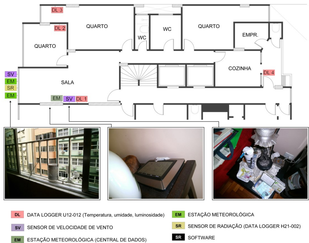
Figuras 74 e 75 – Planta com indicação dos equipamentos (fonte desenho: Concepção Autor e Desenho Foadelli). Fotos dos equipamentos no apartamento (fonte Autor).
