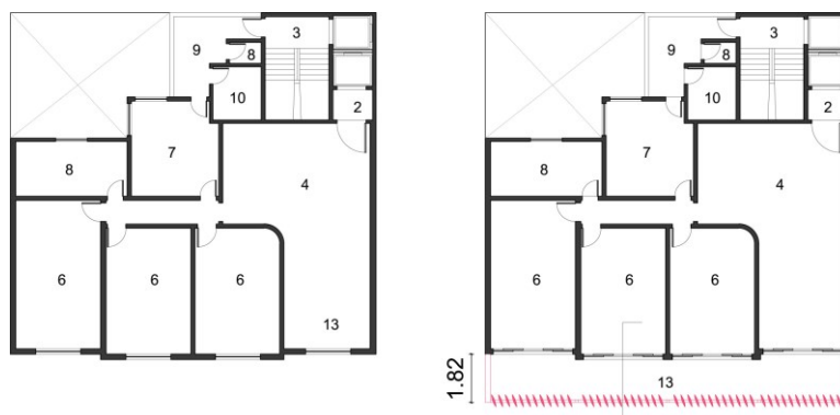
Figura 94 – Edifício Rua Xavier da Silveira, 28: planta atual (esquerda) e a solução proposta (direita) (fonte: Concepção Autor e Desenho Foiadelli).
