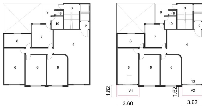
Figura 109 – Edifício Rua Xavier da Silveira, 28: planta atual (esquerda) e a solução proposta (direita) (fonte: Concepção Autor e Desenho Foiadelli).
