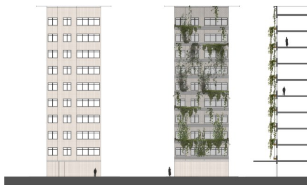
Figura 99 – Edifício Av. Nossa Sra. de Copacabana, 967: Fachada Existente (esquerda), Fachada Proposta (centro) e o Corte Esquemático Proposta (direita) (fonte: Concepção Autor e Desenho Foiadelli).
