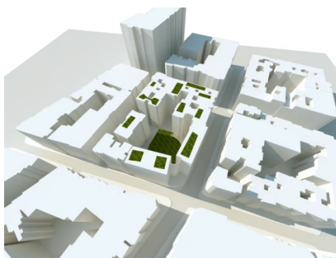
Figura 113 – Quadra com Telhado Verde nos edifícios de forma esquemática (fonte: Concepção Autor e Desenho Foiadelli).
