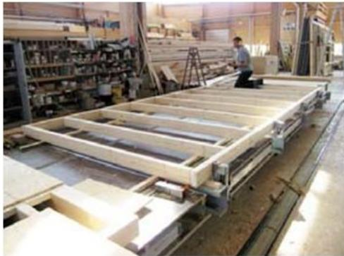
Figura 26 – Fabricação dos Componentes (fonte: Website TES EnergyFaçade<sup>112</sup>).
