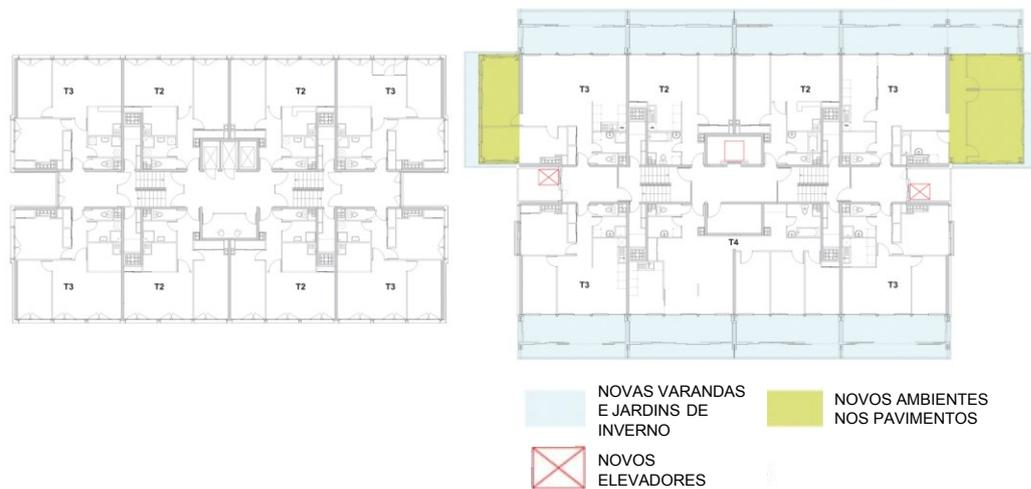
Figura 37 – Pavimento Tipo do Edifício. antes (esquerda) e depois (direita) da reforma (fonte: fonte: Website Lacaton & Vassal<sup>121</sup>. Traduzido pelo Autor).
