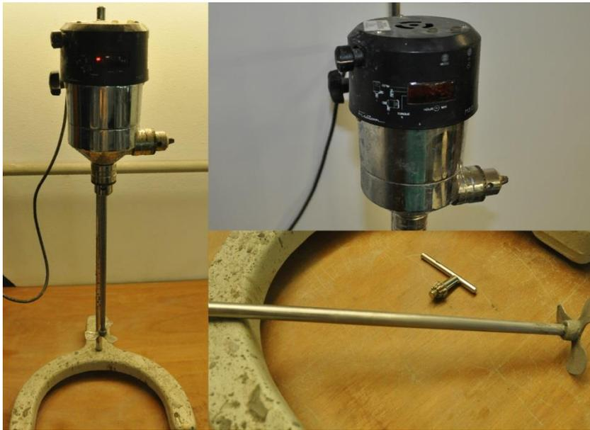
Figura 3.3: Misturador Fisatom, modelo 713D, e palheta.
