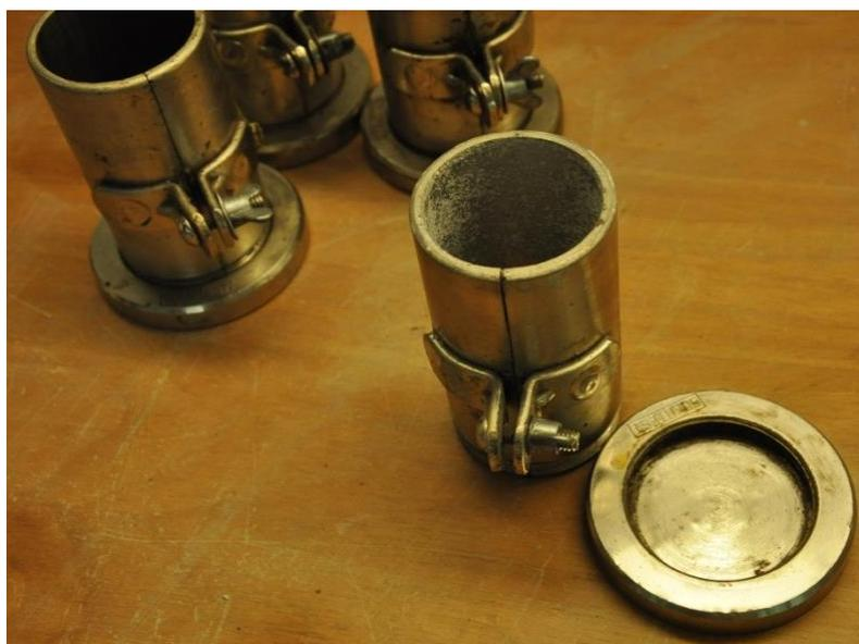
Figura 3.6: Moldes cilíndricos para compressão.
