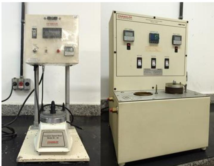
Figura 3.14: Misturador e consistômetro atmosférico da Chandler.
