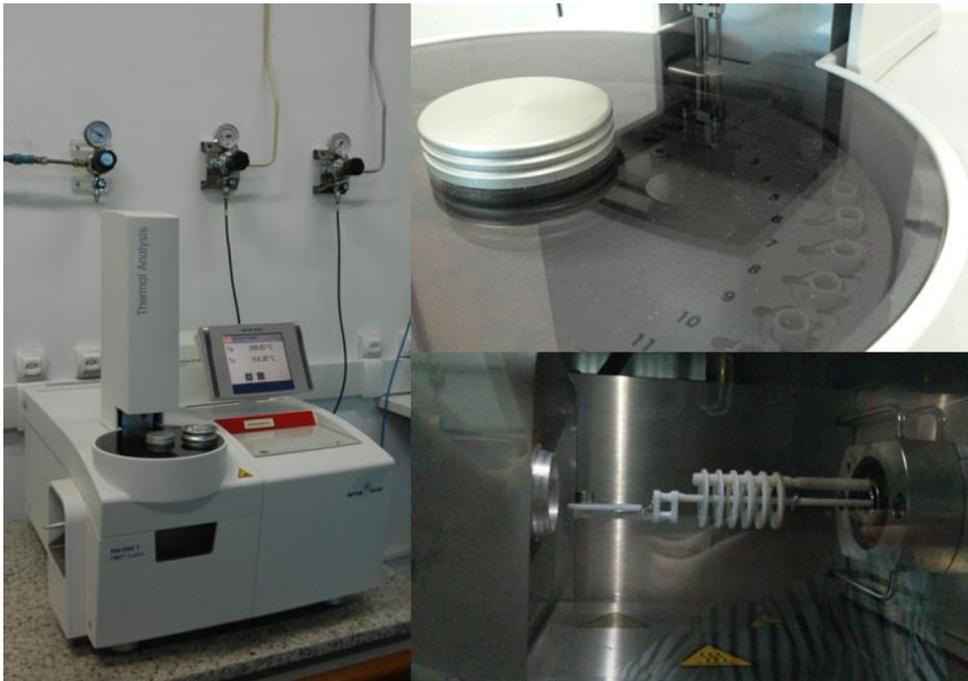
Figura 3.11: Equipamento de análise termogravimétrica Mettler e Toledo, e cadinho sendo inserido no forno pelo braço da balança.
