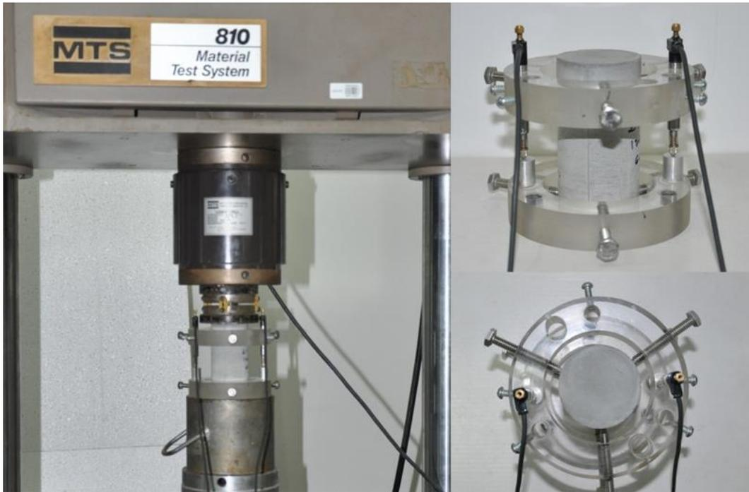
Figura 3.7: Pórtico MTS 810 e corpo de prova instrumentado com LVDTs.
