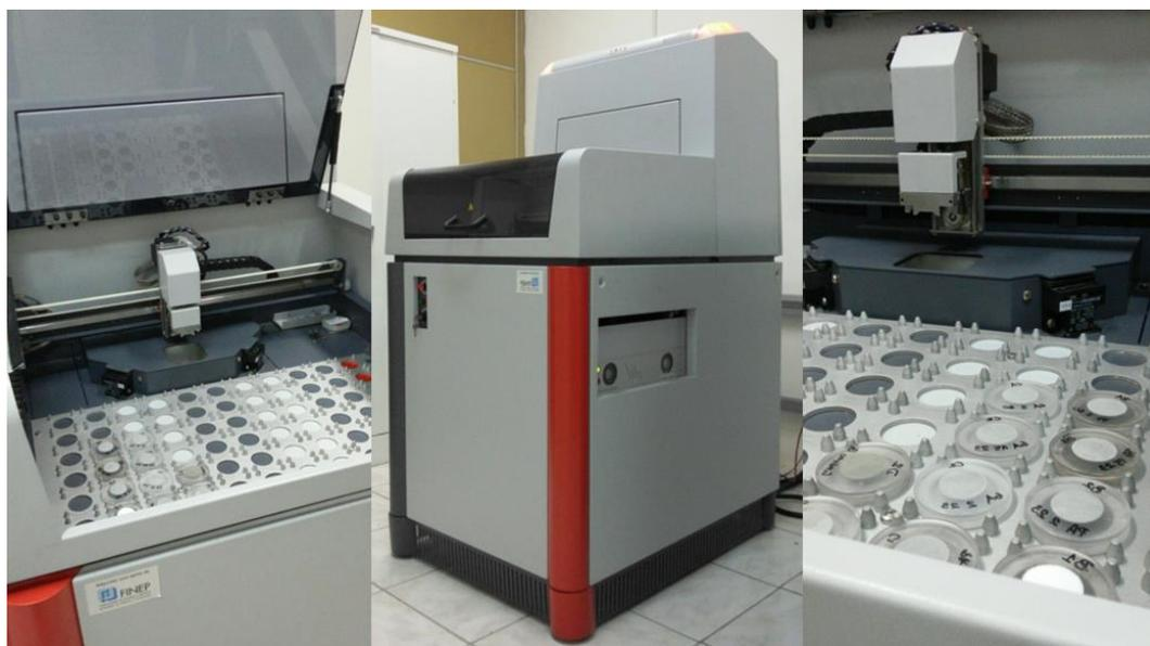
Figura 3.9: Difratorômetro Bruker modelo D4 Endeavour.
