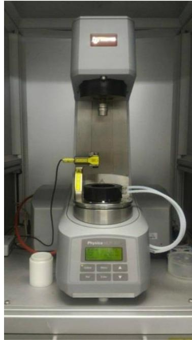
Figura 3.12: Reômetro Anton Paar.
