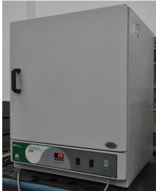
Figura 3.4: Estufa Sterilifer utilizada na cura a 60°C.
