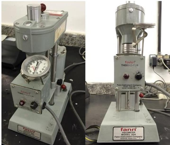
Figura 3.13: Viscosímetro rotativo da Fann.
