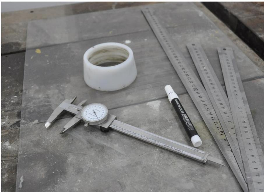
Figura 4.10: Molde, placa de vidro, paquímetro e réguas utilizados nos ensaios de mini-abatimento.
