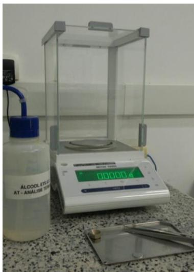
Figura 3.10: Balança Mettler Toledo modelo MS204S/A01.
