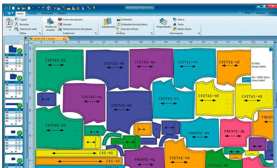
Figura 3.8 – Encaixe automático (Sistema CAD). Fonte: Audaces 7 .
