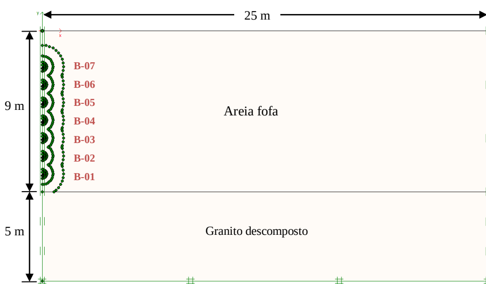
Figura 5.7 - Geometria do problema com indicação dos bulbos de injeção (B-01 a B-07).
