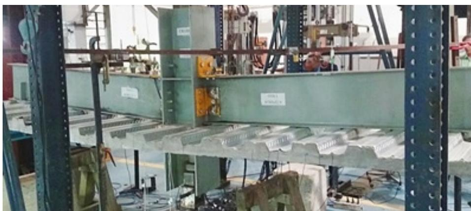
**Figura 5.35 - Detalhe da rotação da ligação (Ensaio 2)**
