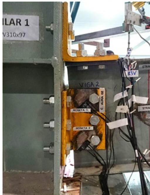
**Figura 5.33 – Detalhe da cantoneira de alma durante o Ensaio 2**
