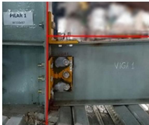
**Figura 5.20 - Detalhe da rotação da ligação ao final do Ensaio 1**
