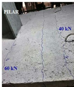
**Figura 5.12 – Detalhe da primeira fissura observada (40 kN) e da fissura na linha do pilar (60kN)**
