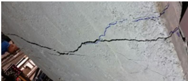
**Figura 5.30 - Detalhe da fissura que determinou o final do Ensaio 2**
