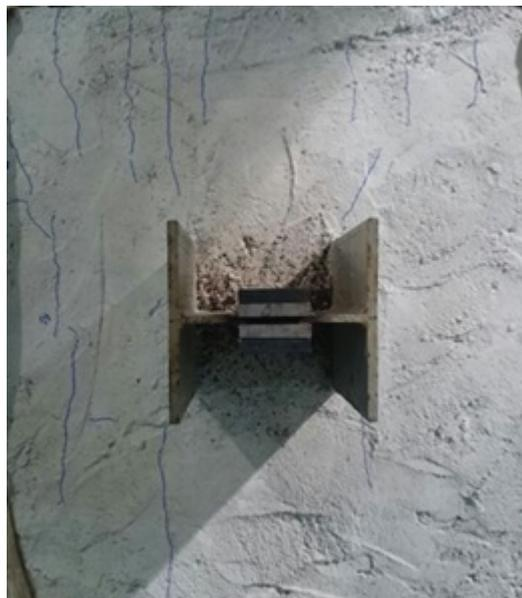
**Figura 5.31 - Detalhe das fissuras nas proximidades do pilar do Ensaio 2**
