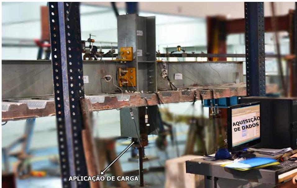
**Figura 4.38 - Detalhe do sistema de aplicação de carga e da aquisição de dados, Ensaio 2**
