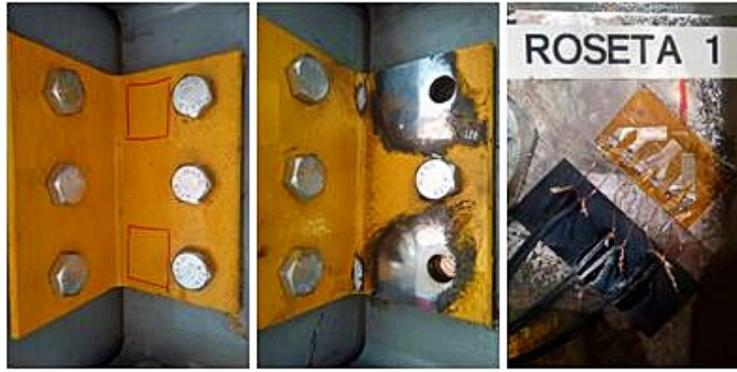
Figura 4.28 – Instrumentação: detalhe da sequência para colagem das rosetas na cantoneira de alma
