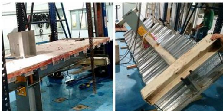
**Figura 4.24 - Transporte e inversão do modelo experimental, respectivamente**
