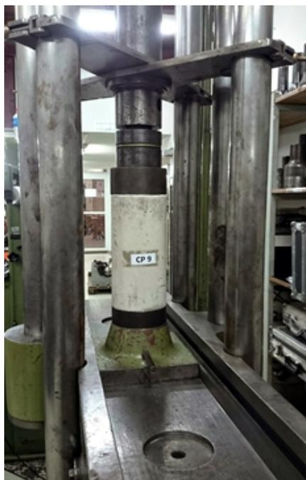
**Figura 4.16 – Detalhe da máquina utilizada para o ensaio de compressão**
