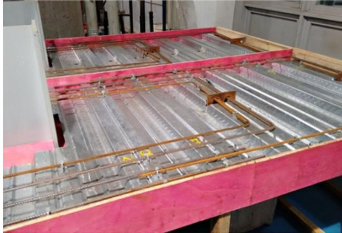
**Figura 4.20 – Detalhe da armadura principal**
