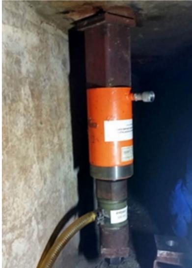
**Figura 4.39 - Detalhe do atuador fixado na laje de reação, Ensaio 2**
