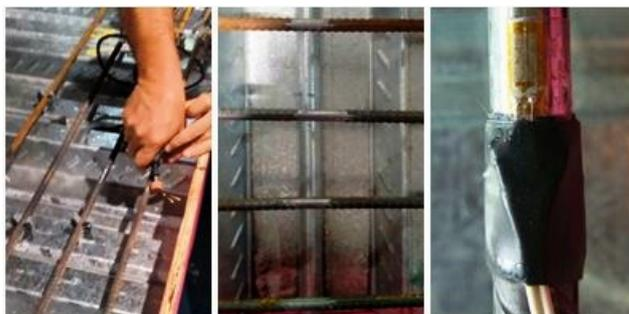
Figura 4.25 - Instrumentação: “*strain gauges*” nos vergalhões
