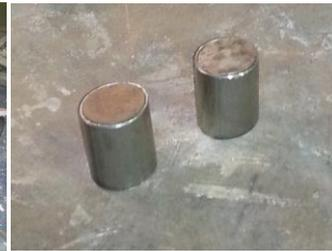
Figura 234 - Tubos conexão com tampas soldadas
