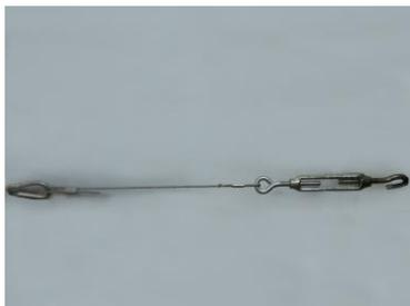
Figura 258 - Destaque conjunto cabeamento ligações oblíquas
