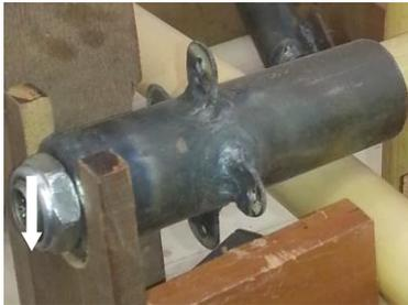
Figura 237 - Conexão da roda traseira
