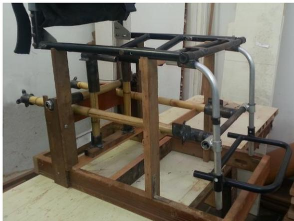
Figura 246 - Gabarito montado com hastes e conexões de metal
