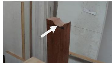
Figura 214 - Gabarito: Encaixe côncavo dos tubos
