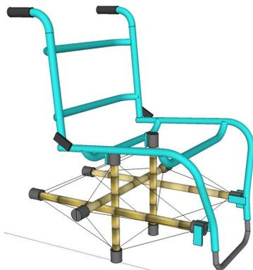
Figura 219 - Estrutura *tensegrity* com conjunto de uso
