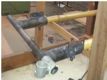
Figura 239 - Acabamento das hastes horizontais com encaixe do conjunto de uso
