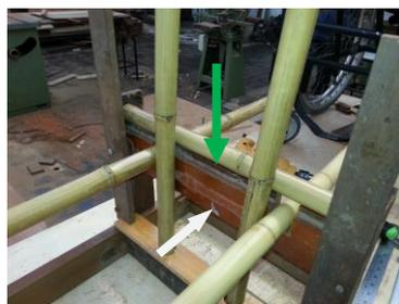
Figura 226 - Haste transversal (indicado em verde) e suporte (indicado em branco)
