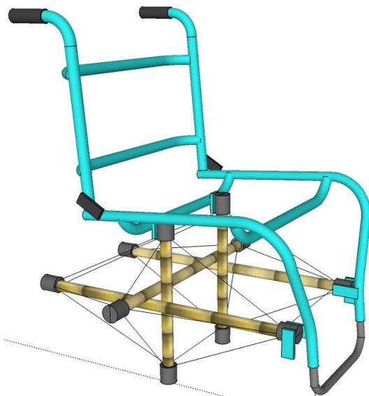
Figura 208 - Conjunto de uso com estrutura *tensegrity*
