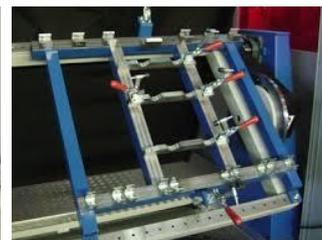
Figura 195 - Gabarito para fabricação de estrutura metálica
