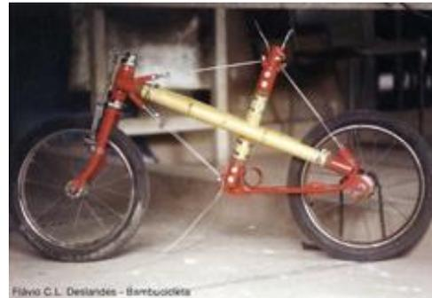
Figura 110 - Bicicleta *tensegrity* - Detalhe
