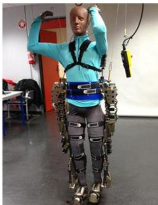
Figura 2 - Exoesqueleto em teste
