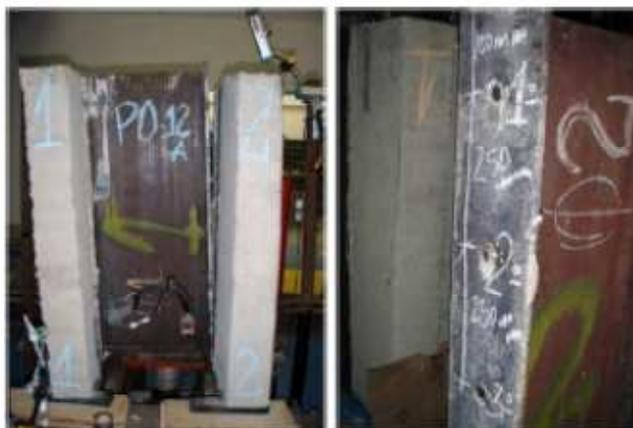
Figura 4.44 – Ruptura do ensaio PO.12.r (Ramires, 2010).
