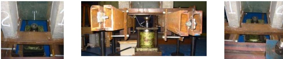
**Figura 4.36 – Macaco hidráulico sem a cabeça rotulada.**
