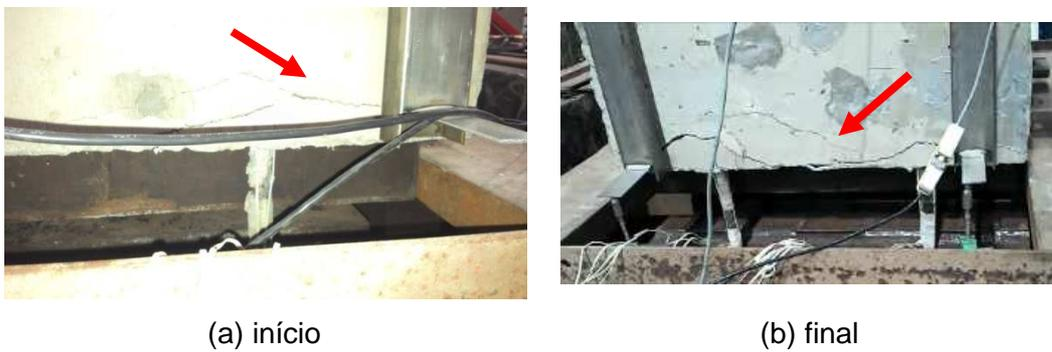
**Figura 4.77 – Rompimento da ancoragem – PO.12.**
