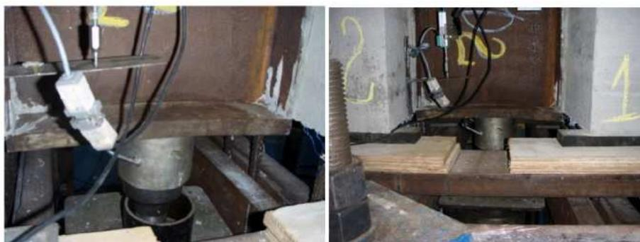
**Figura 4.96 – Colapso na alma do perfil metálico no ensaio PO.22.r (Ramires, 2010).**
