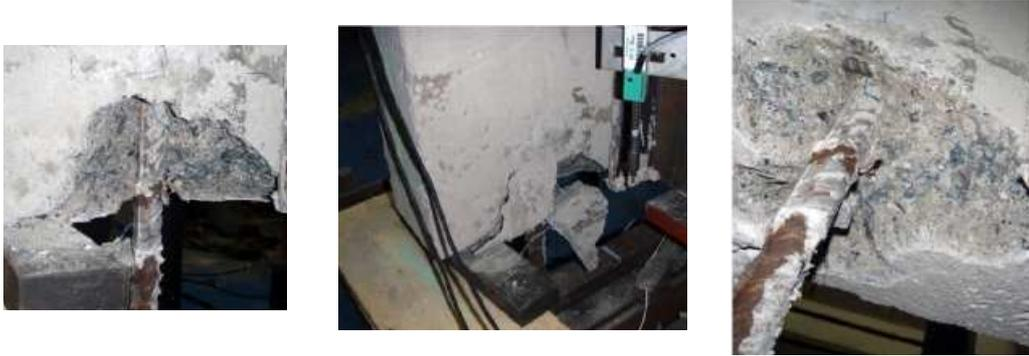
Figura 4.84 – Ruptura da ancoragem no ensaio PO.72.r (Ramires, 2010).
