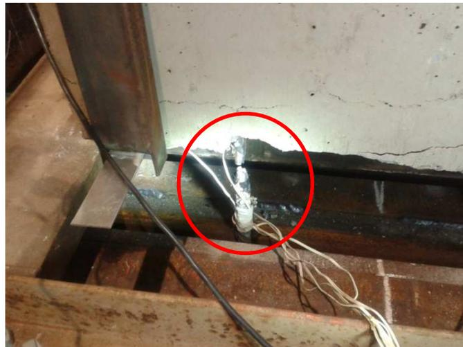
**Figura 4.69 – Rompimento da barra – PO 11.**
