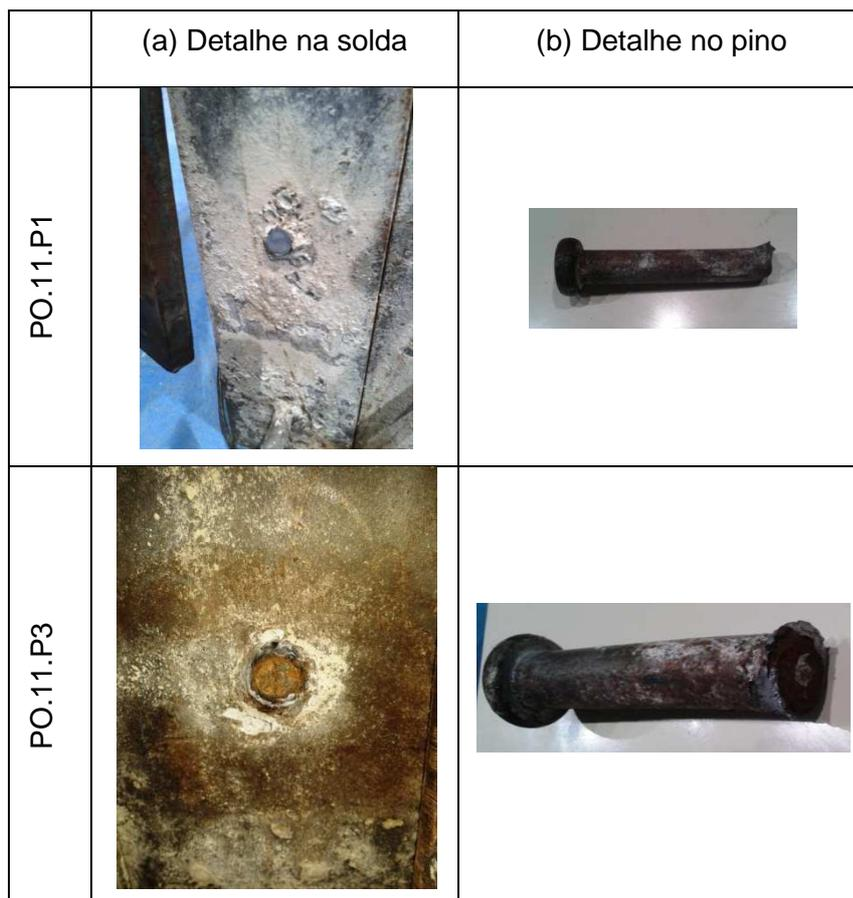
**Figura 4.15 – Ensaio do perfil PO.11: (a) detalhe na solda e (b) detalhe no pino.**
