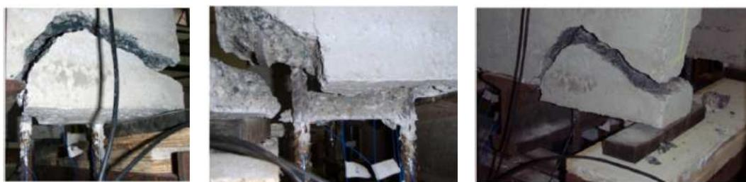
**Figura 4.90 – Ruptura da ancoragem da barra de armadura do ensaio PO.82.r (Ramires, 2010).**
