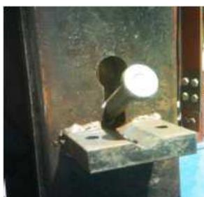
(c) Detalhe do conector e seu rompimento
