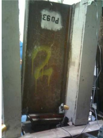
Figura 4.62 – Rompimento da solda do conector - PO.93.
