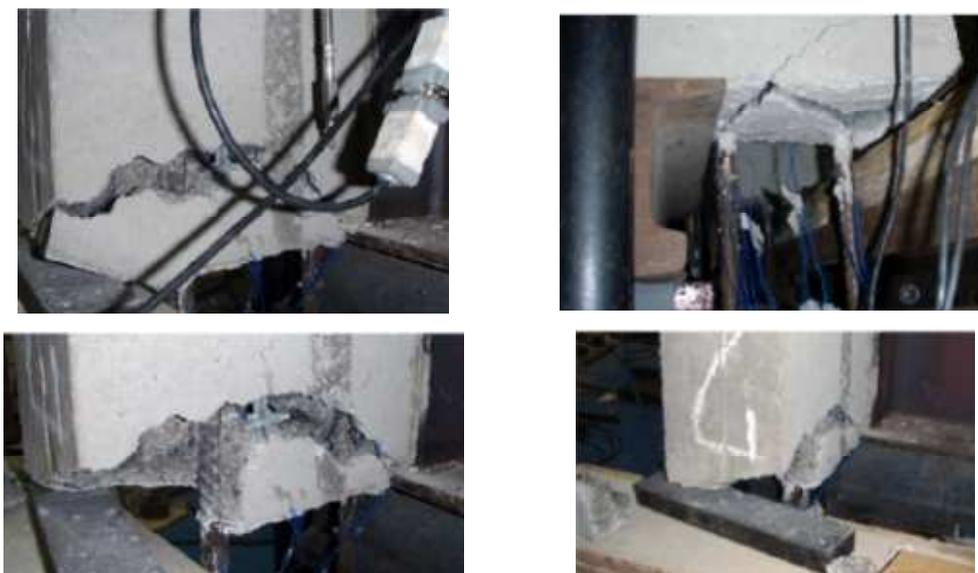
**Figura 4.91 – Ruptura da ancoragem da barra de armadura do ensaio PO.83.r (Ramires, 2010).**
