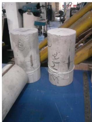
**Figura 4.35 – Corpo de prova para determinação do módulo de elasticidade.**
