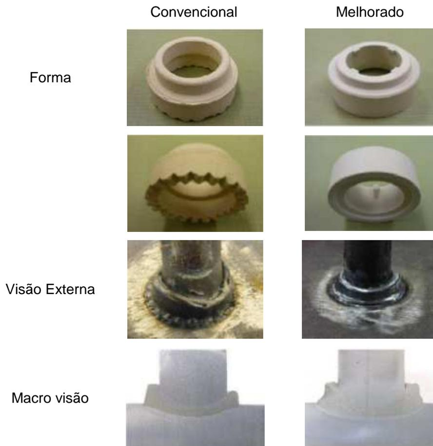
**Figura 1.15 – Comparação entre os *studs* soldados de forma convencional e melhorados (adaptado de Higashiyama et al., 2013).**
