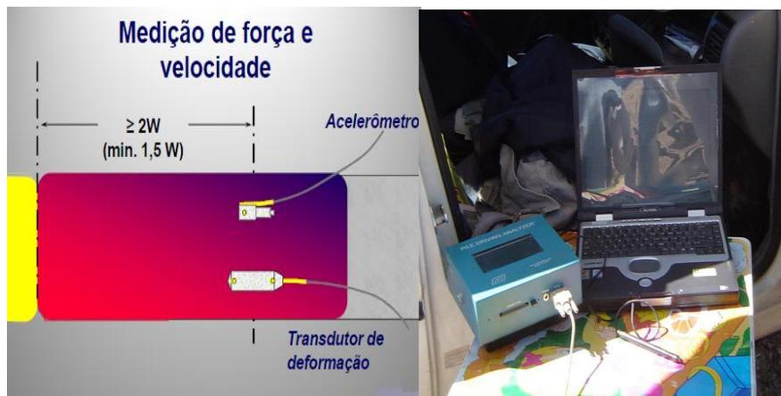
Figura 2.19 - Posição dos sensores com respeito ao topo da estaca e analisador de sinal tipo PDA (Pile Driving Analyzer).
