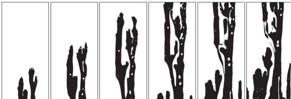
Figura 4.116: Solução de goma xantana 0,40% deslocando óleo mineral –  $\dot{\gamma} = 136,417$  1/s;  $u^* = \dot{\gamma}^* = 5,439$ ;  $\eta^* = 0,384$ ;  $\dot{m} = 0,591$  g/s;  $Re = 0,264$ ;  $We = 1,524 \cdot 10^{-3}$ ;  $Ca = 2,489 \cdot 10^{-2}$ ;  $T = 24^\circ C$ ;  $\varepsilon = 37,168\%$ , *Fingers*.
