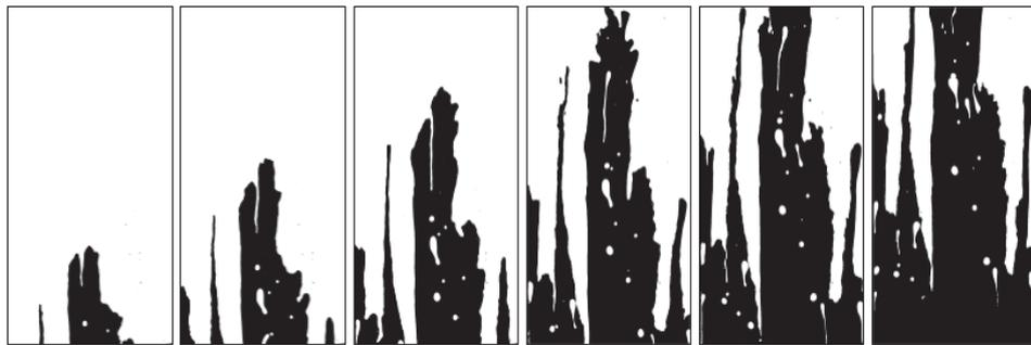
Figura 4.114: Solução de goma xantana 0,40% deslocando óleo mineral –  $\dot{\gamma} = 80,803$  1/s;  $u^* = \dot{\gamma}^* = 3,222$ ;  $\eta^* = 0,419$ ;  $\dot{m} = 0,350$  g/s;  $Re = 0,106$ ;  $We = 5,349 \cdot 10^{-4}$ ;  $Ca = 3,672 \cdot 10^{-2}$ ;  $T = 24^\circ C$ ;  $\varepsilon = 65,525\%$ , *Fingers*.
