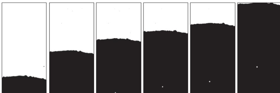
Figura 4.105: Solução de goma xantana 0,40% deslocando óleo mineral –  $\dot{\gamma} = 12,477$  1/s;  $u^* = \dot{\gamma}^* = 0,408$ ;  $\eta^* = 1,946$ ;  $\dot{m} = 0,054$  g/s;  $Re = 0,004$ ;  $We = 1,275 \cdot 10^{-5}$ ;  $Ca = 1,793 \cdot 10^{-1}$ ;  $T = 26^\circ C$ ;  $\varepsilon = 99,293\%$ , *Plug*.
