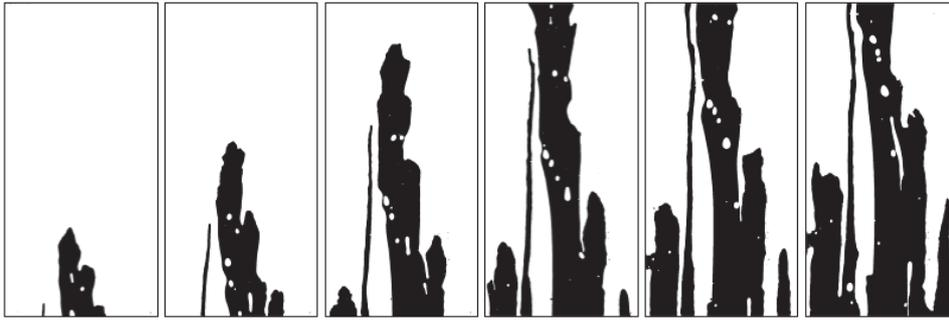
Figura 4.115: Solução de goma xantana 0,40% deslocando óleo mineral –  $\dot{\gamma} = 107,904$  1/s;  $u^* = \dot{\gamma}^* = 4,302$ ;  $\eta^* = 0,338$ ;  $\dot{m} = 0,467$  g/s;  $Re = 0,175$ ;  $We = 9,538 \cdot 10^{-4}$ ;  $Ca = 2,962 \cdot 10^{-2}$ ;  $T = 24^\circ C$ ;  $\varepsilon = 45,537\%$ , *Fingers*.
