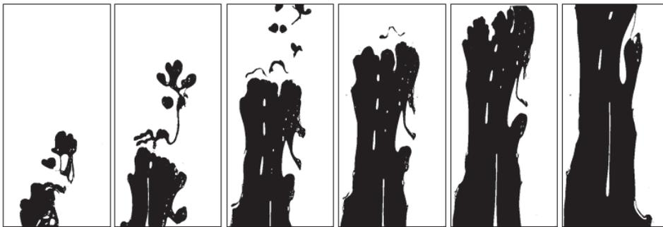
Figura 4.65: Solução de poliacrilamida 0,25% deslocando óleo mineral –  $\dot{\gamma} = 228,3481/s$ ;  $u^* = \dot{\gamma}^* = 9,374$ ;  $\eta^* = 0,203$ ;  $\dot{m} = 1,061$  g/s;  $Re = 0,582$ ;  $We = 4,862.10^{-6}$ ;  $Ca = 1,793.10^{-2}$ ;  $T = 22^\circ C$ ;  $\varepsilon = 55,940\%$ , *Fingers*.
