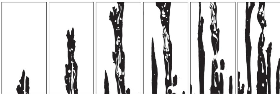
Figura 4.119: Solução de goma xantana 0,40% deslocando óleo mineral –  $\dot{\gamma} = 179,466$  1/s;  $u^* = \dot{\gamma}^* = 7,15$ ;  $\eta^* = 0,232$ ;  $\dot{m} = 0,777$  g/s;  $Re = 0,426$ ;  $We = 2,638 \cdot 10^{-3}$ ;  $Ca = 2,030 \cdot 10^{-2}$ ;  $T = 24^\circ C$ ;  $\varepsilon = 32,940\%$ , *Fingers*.
