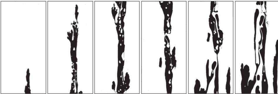
Figura 4.123: Solução de goma xantana 0,40% deslocando óleo mineral –  $\dot{\gamma} = 276,971$  1/s;  $u^* = \dot{\gamma}^* = 11,043$ ;  $\eta^* = 0,168$ ;  $\dot{m} = 1,199$  g/s;  $Re = 0,907$ ;  $We = 6,284.10^{-3}$ ;  $Ca = 1,479.10^{-2}$ ;  $T = 24^\circ C$ ;  $\varepsilon = 25,609\%$ , *Fingers*.
