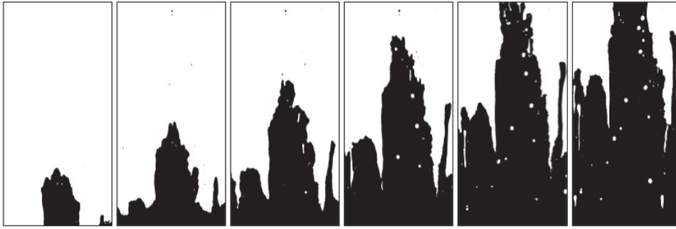
Figura 4.112: Solução de goma xantana 0,40% deslocando óleo mineral –  $\dot{\gamma} = 64,077$  1/s;  $u^* = \dot{\gamma}^* = 2,555$ ;  $\eta^* = 0,498$ ;  $\dot{m} = 0,277$  g/s;  $Re = 0,071$ ;  $We = 3,363 \cdot 10^{-4}$ ;  $Ca = 4,363 \cdot 10^{-2}$ ;  $T = 24^\circ C$ ;  $\varepsilon = 75,448\%$ , *Fingers*.
